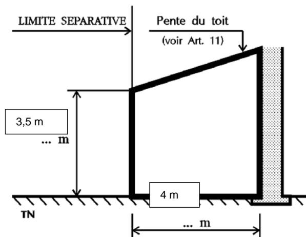
La construction dont la hauteur mesurée sur la dite limite ne dépasse pas 3,5 m est autorisée. Entre la limite de propriété et la limite de recul (c'est-à-dire 4 m), la hauteur de tout point de la construction doit s'inscrire à l'intérieur du schéma ci-contre.
