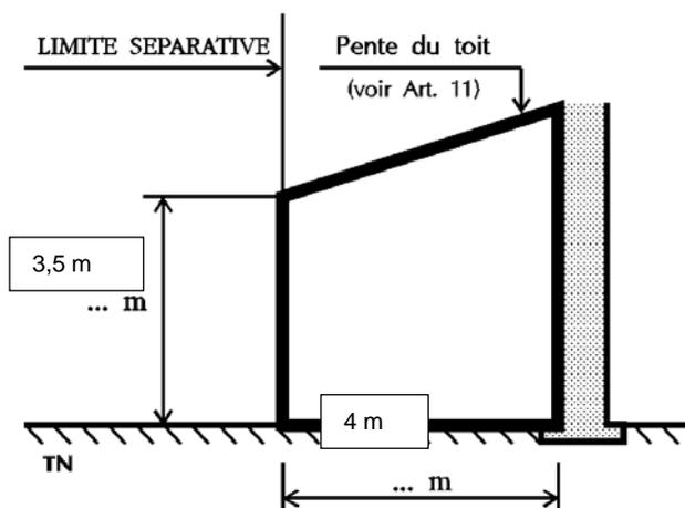
La construction dont la hauteur mesurée sur ladite limite ne dépasse pas 3,5 m est autorisée. Entre la limite de propriété et la limite de recul (c'est-à-dire 4 m), la hauteur de tout point de la construction doit s'inscrire à l'intérieur du schéma ci-contre.
