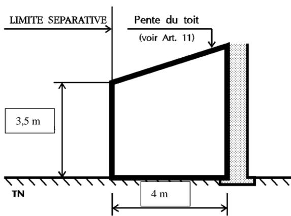
La construction des bâtiments dont la hauteur mesurée sur ladite limite ne dépasse pas 3,5 m est autorisée. Entre la limite de propriété et la limite de recul (c'est-à-dire 4 m), la hauteur de tout point de la construction doit s'inscrire à l'intérieur du schéma ci-contre.
