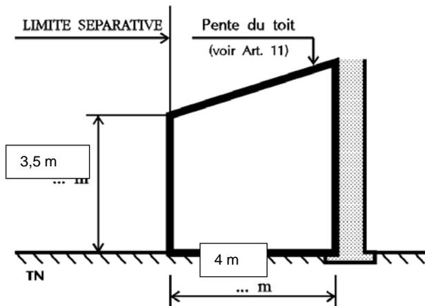
La construction dont la hauteur mesurée sur la dite limite ne dépasse pas 3,5 m est autorisée. Entre la limite de propriété et la limite de recul (c'est-à-dire 4 m), la hauteur de tout point de la construction doit s'inscrire à l'intérieur du schéma ci-contre.
